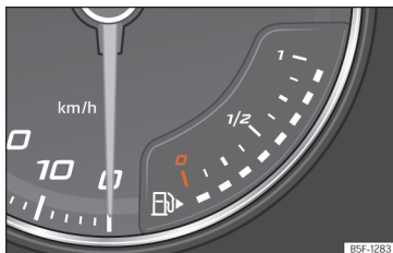
Рис. 6 Аналогова комбінація приладів: показник рівня пального.
