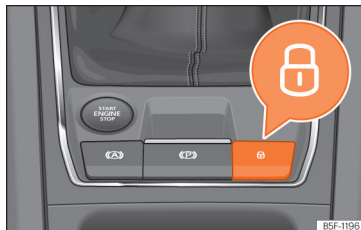
Рис. 76 Центральна консоль: клавіша центрального замка.
