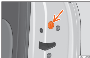
Рис. 78 Аварійне (механічне) замикання дверей.
