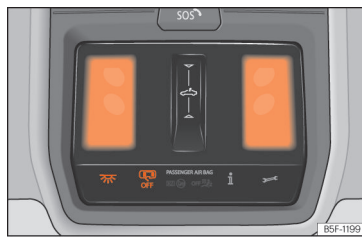
Рис. 106 Стельова консоль: передній ліхтар освітлення салону.
