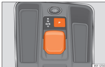
Рис. 122 Центральна консоль: селектор режимів трансмісії.
