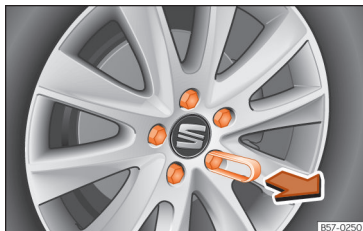
Рис. 244 Колесо: Колісні болти з ковпачками.
