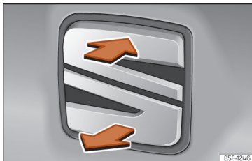
Рис. 80 Кришка багажника: відкривання ззовні.
