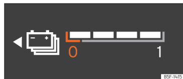
Рис. 8 Цифрова комбінація приладів: показник рівня заряду батареї.
