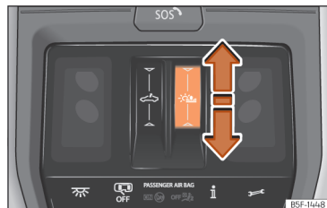
Рис. 89 Стельова консоль: управління сонцезахисною шторкою
