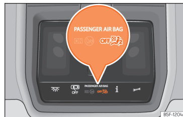
Рис. 32 Стельова консоль: індикатор відключення подушки безпеки пасажирів.
