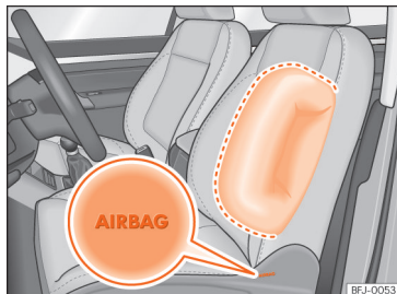
Рис. 35 Бокова подушка безпеки в спинці сидіння водія.
