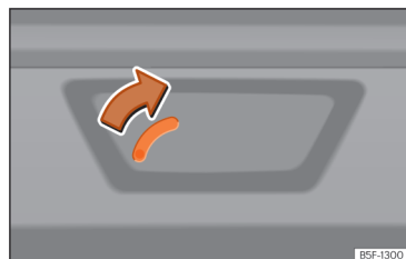
Рис. 85 Багажний відсік: аварійне відмикання (Leon Sportstourer).
