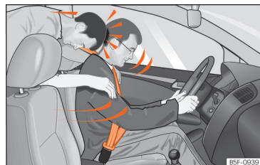
Рис. 22 Непристебнутого пасажирів сильно кидає вперед, вдаряючи об водія, який користується ремінем безпеки.
