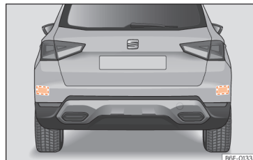
Рис. 97 Вид автомобіля ззаду: Датчики радару у задньому бампері.
