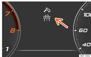
Рис. 102 Допоміжні вказівки для екологічно ефективного водіння (схематичний вигляд).
