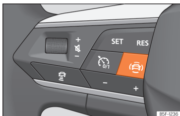
Рис. 93 Лівий бік багатофункціонального керма: клавіша для асистентів водія (залежно від версії).
