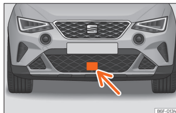
Рис. 94 Передній бампер: датчик радар.
