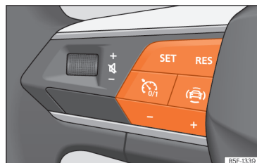
Рис. 101 Багатофункціональне кермо: клавіші управління обмежувачем швидкості.
