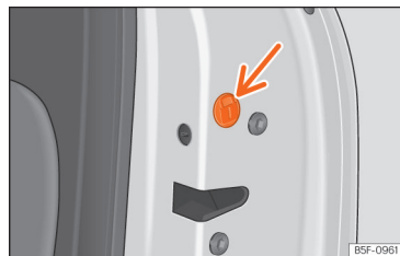
Рис. 55 Аварійне (механічне) замикання дверей.
