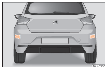
Рис. 99 Вид автомобіля ззаду: Датчики радару у задньому бампері.
