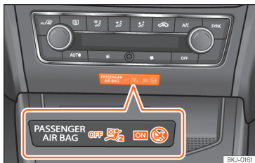
Рис. 30 Центральна консоль: індикатор стану подушки безпеки пасажирів
