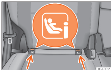
Рис. 42 Заднє сидіння: позначення кріплень ISOFIX/i-Size.
