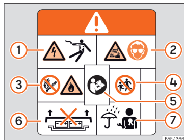
Рис. 53 Попереджувальні знаки на високовольтному акумуляторі.
