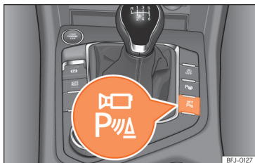
Рис. 171 Центральна консоль: клавіша для ручного вмикання/вимикання системи Top View Camera на центральній консолі авто з асистентом паркування.
