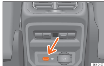
Рис. 186 Задня частина центральної консолі: USB-порти з функцією розетки.
