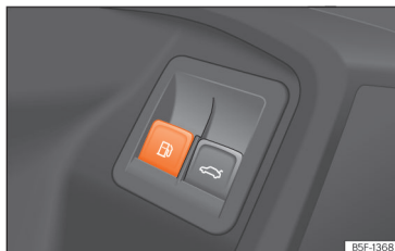
Рис. 216 Двері водія: розблокування лючка паливного бака.
