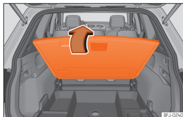
Рис. 199 Багажний відсік: піднімання панелі підлоги.
