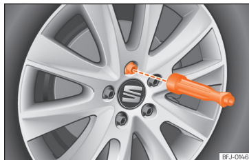
Рис. 257 Заміна колеса: викручування болтів рукояткою викрутки.
