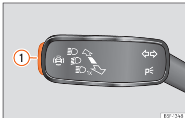
Рис. 130 Перемикач показників повороту: кнопка виклику меню допоміжних систем (залежно від версії).
