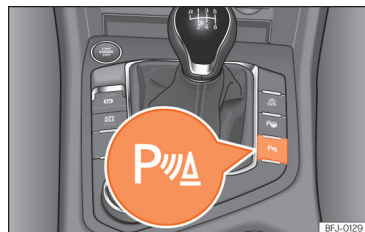
Рис. 159 Центральна консоль: вимикач асистента паркування (залежно від версії).
