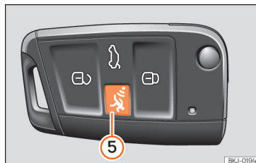
Рис. 65 Ключ із тривожною кнопкою.
