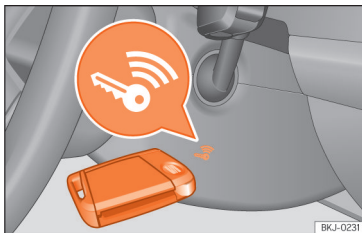
Рис. 120 Праворуч від керма: аварійний пуск двигуна.
