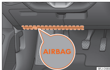
Рис. 37 З боку водія: місце розташування подушки для захисту колін.
