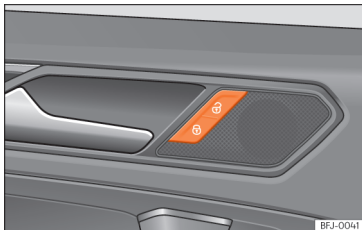
Рис. 71 Двері водія: клавіша центрального замка.
