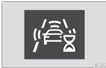
Рис. 146 Дисплей комбінації приладів: індикація самокалібрування системи.
