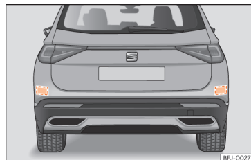
Рис. 135 Вид автомобіля ззаду: Датчики радару у задньому бампері.
