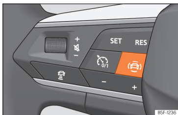
Рис. 131 Лівий бік багатофункціонального керма: клавіша для асистентів водія (залежно від версії).
