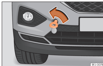
Рис. 226 Правий бік переднього бампера: вкручування буксирувального вушка
