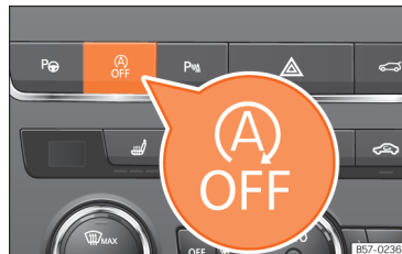
Рис. 99 Центральна консоль: вимикач системи Старт-Стоп
