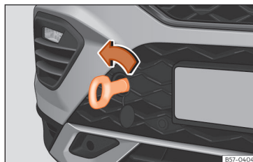
Рис. 198 Правий бік переднього бампера: вкручування буксирувального вушка
