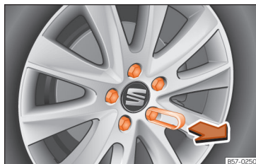
Рис. 224 Колесо: Колісні болти з ковпачками.
