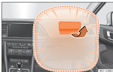
Рис. 28 Подушка безпеки пасажирів в передній панелі.
