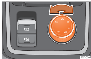
Рис. 105 Центральна консоль: Поворотний перемикач (Driving Experience button).
