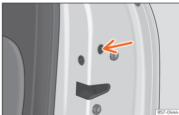
Рис. 57 Аварійне (механічне) замикання дверей.
