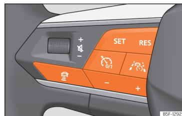
Рис. 129 Лівий бік багатофункціонального керма.
