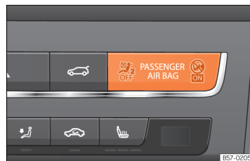
Рис. 30 Центральна консоль: індикатор стану подушки безпеки пасажирів
