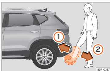
Рис. 62 Кришка багажника з функцією безконтактного відкривання й закривання (Easy Open).
