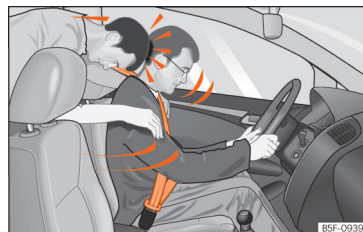
Рис. 22 Непристебнутого пасажирів сильно кидає вперед, вдараючи об водія, який користується ремнем безпеки.
