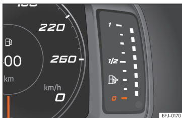
Рис. 6 Цифрова комбінація приладів: показник рівня пального.
